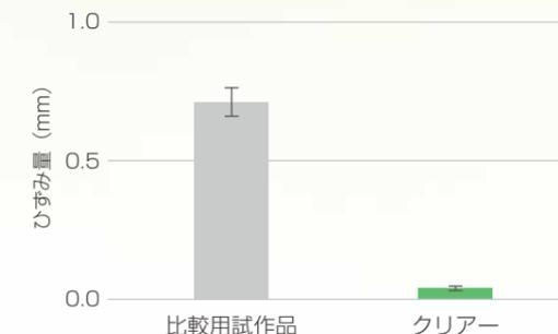
硬化前の厚み (0.5 mm) からの硬化変形した厚み (ひずみ量) が大幅に低減されています。
