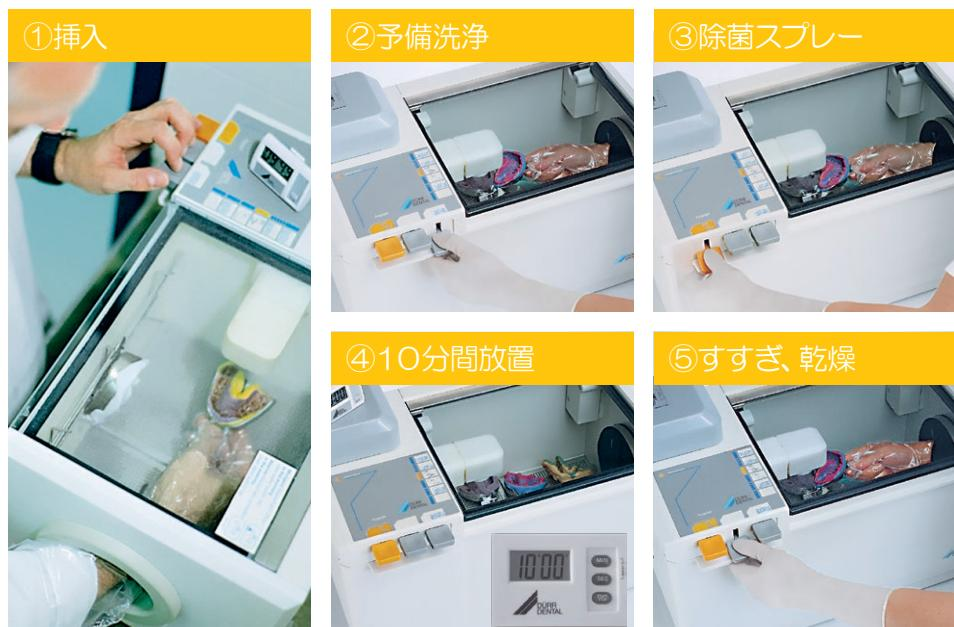
ハイゴジェット設置にはエアー、水道と排水の接続が必要です。「MD520インプレッション」の印象体／技工物の除菌液を使用します。
